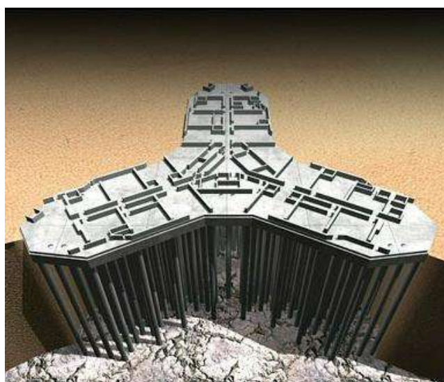
Slika 24 Primjer hibridnog temeljenja Burj Khalife
