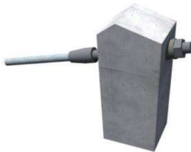
Slika 37. Spoj užeta s betonskim stupom
