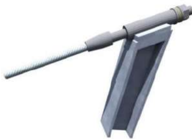
Slika 36. Spoj užeta s čeličnim stupom
