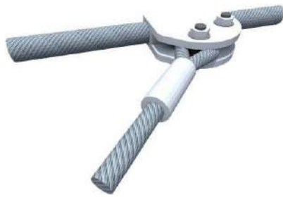
Slika 35. Spoj s rubnim užetom
