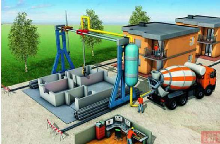
Slika 6. Proces printanja cijele zgrade
