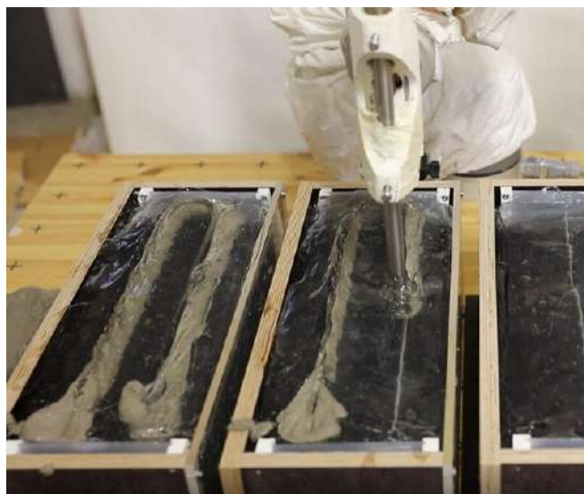
Slika 14. Stvarni prikaz postupka injektiranja betona u suspenziju
