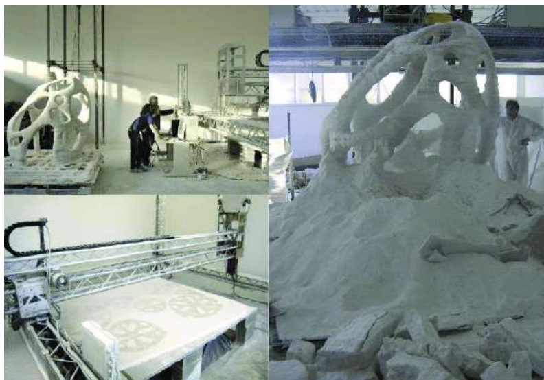
Slika 11. Proces uklanjanja nevezanog materijala
