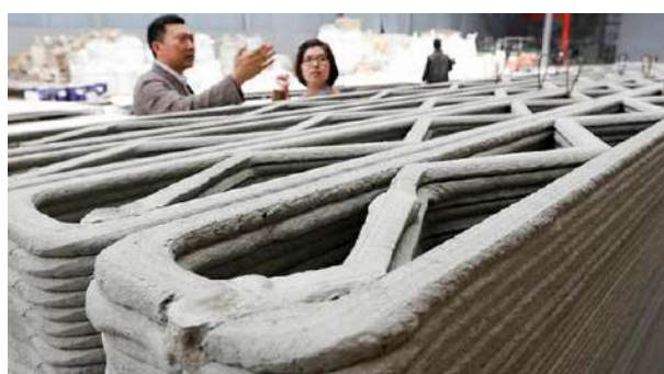
Slika 20. Prikaz rešetkaste ispune
