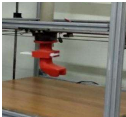
Slika 35. Vrh mlaznice pod 0^\circ na smjer printanja
