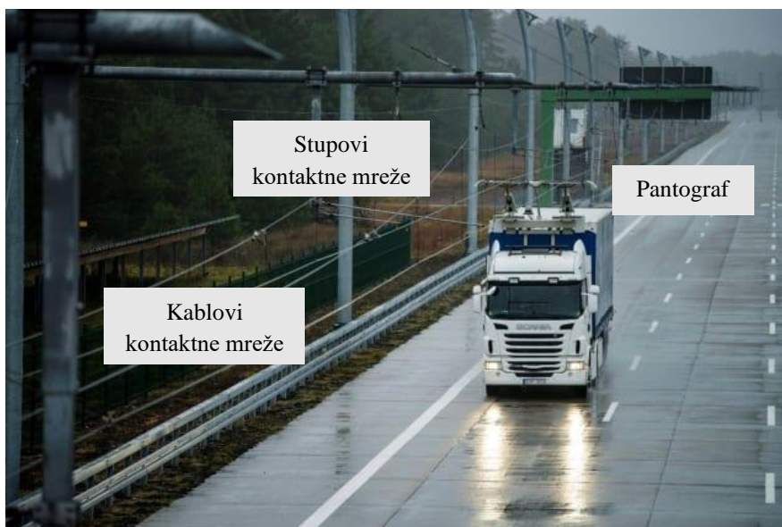
Slika 3.2: Konduktivni ECS s kontaktnom mrežom iznad vozila (slika preuzeta i prilagođena iz [9]).
