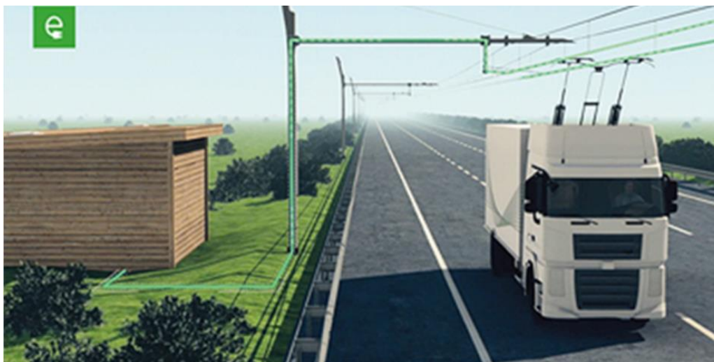
Slika 5.4: Ilustracija sustava eHighway. U lijevom rubu vidljiva je trafostanica. [6]
