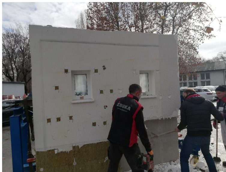
Slika 42: Postojeći uzorak za kondicioniranje ETICS sustava
