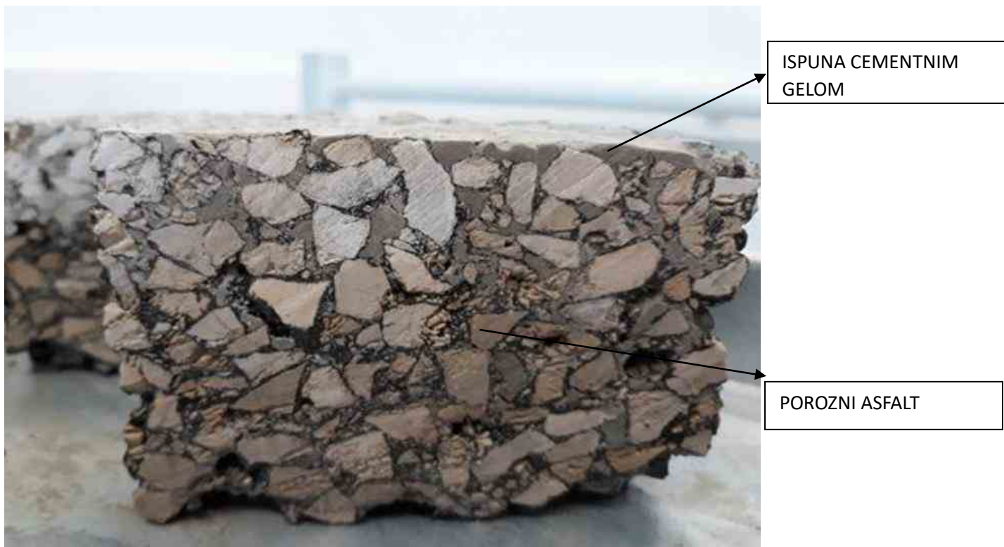
Slika 1. Presjek poroznog asfalta ispunjenog cementnim gelom [5]
