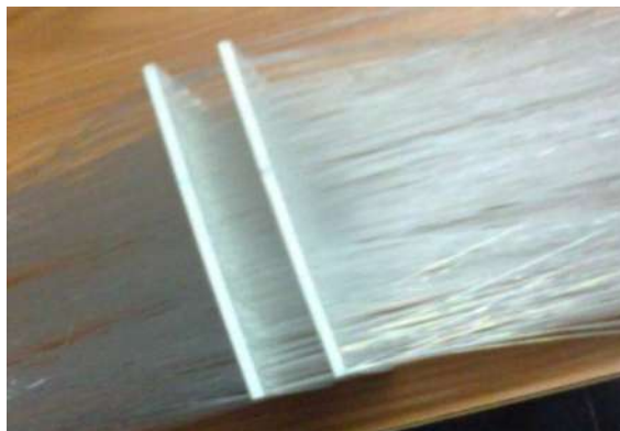
Slika 65. Optička vlakna provučena kroz kalup [35]
