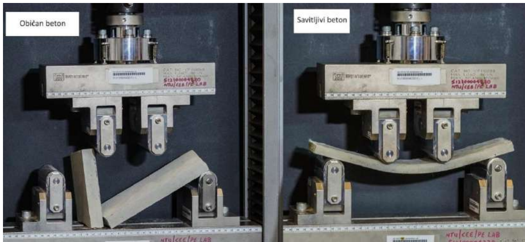
Slika 32. Ispitivanje na savijanje [3]
