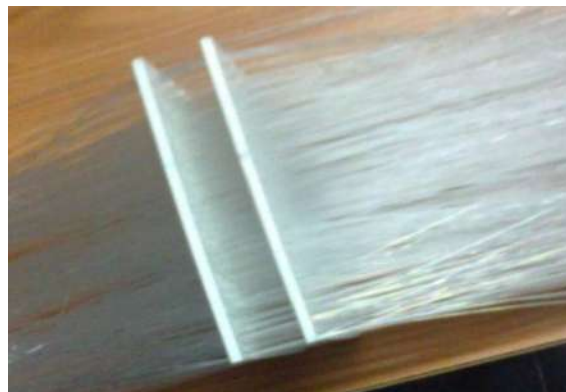
Slika 65. Optička vlakna provučena kroz kalup [35]
