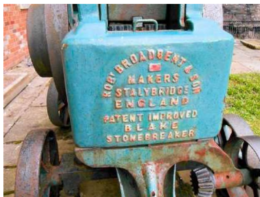
Slika 9. Stroj za drobljenje klinkera, Blake Stonebreaker [8]
