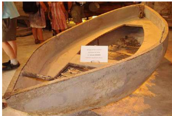
Slika 8. Joseph Lambot, žičani čamac obložen mortom [7]
