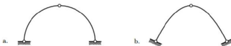
Slika 2. Primjer modela trozglobnih lukova (iz [9])
