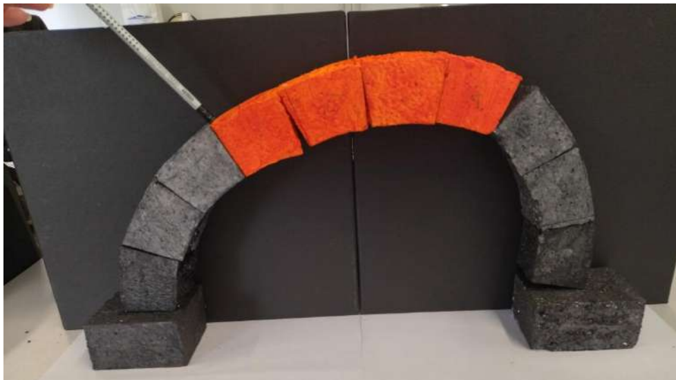
Slika 34. Model luka netom prije sloma zbog djelovanja koncentrirane sile
