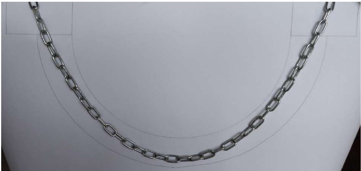
Slika 26. Tlačna linija u luku
