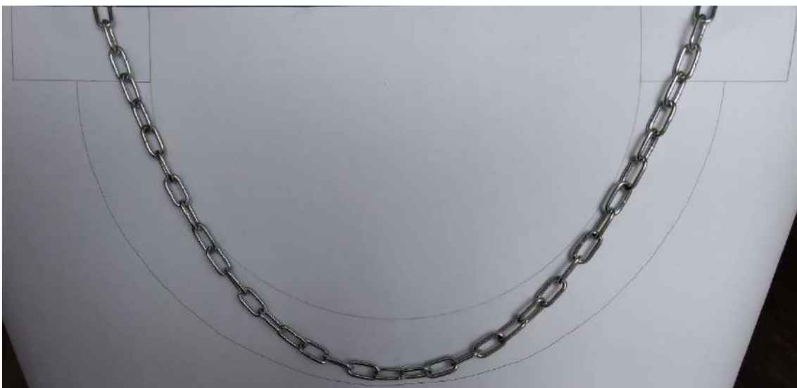
Slika 28. Tlačna linija kod povećanja raspona
