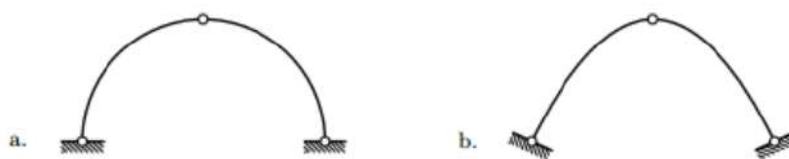
Slika 2. Primjer modela trozglobnih lukova (iz [9])
