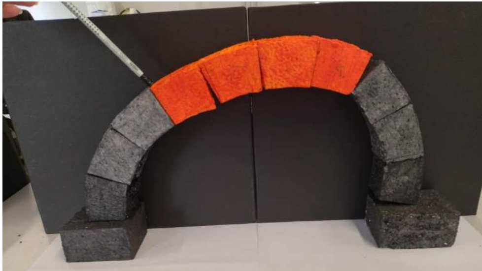
Slika 34. Model luka netom prije sloma zbog djelovanja koncentrirane sile
