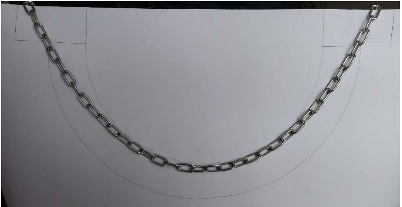
Slika 30. Tlačna linija kod smanjenja raspona
