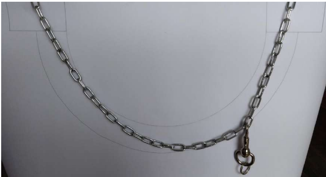
Slika 32. Tlačna linija kod djelovanja koncentriranog opterećenja
