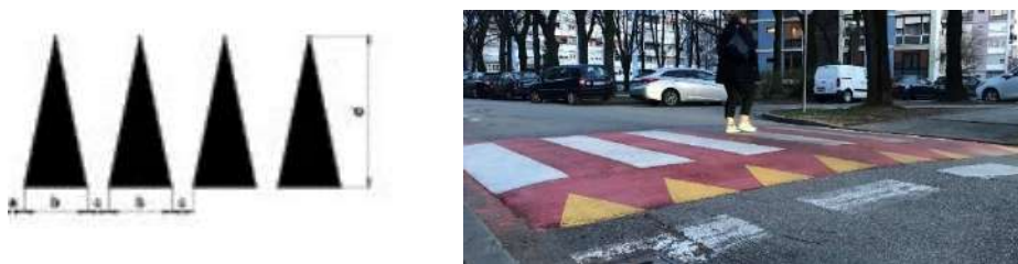
Slika 27 Detalj [5] i primjer oznake (H55-1) duž cijele uzdignute plohe
