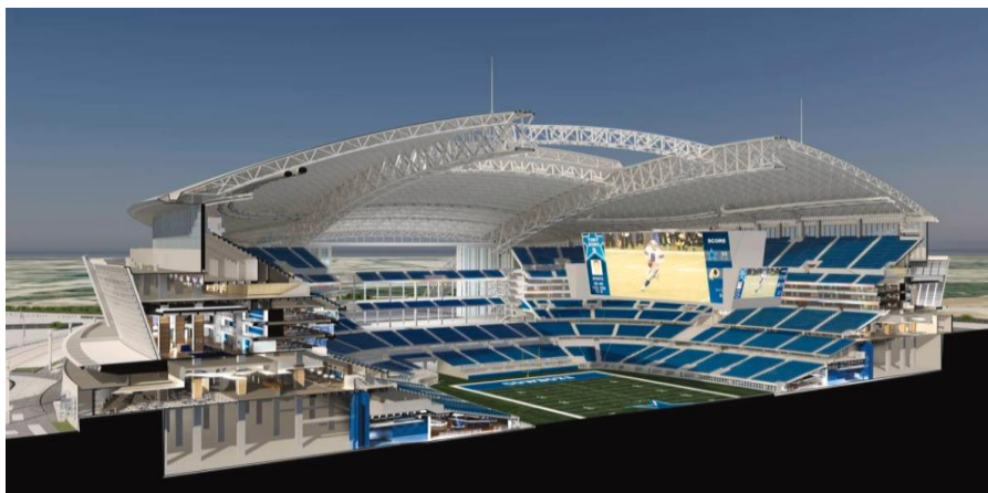
Slika 26. Presjek konstrukcije AT&T stadiona
