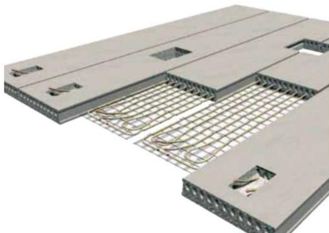
Slika 30. Provođenje instalacija kroz šuplje prednapregnute ploče
