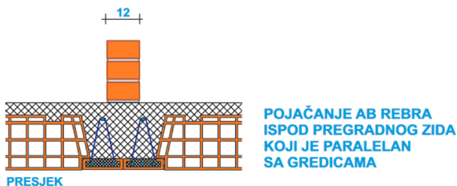
Slika 22. Pojačanje AB rebra ispod pregradnog zida koji je paralelan sa gredicama
