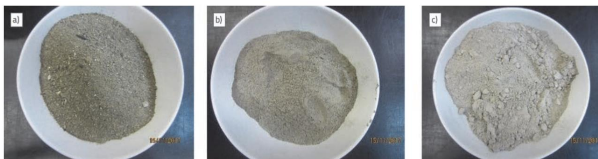
Slika 3. Uzorci pepela drvene biomase: a) pepeo s dna peći; b) leteći pepeo krupnije frakcije; c) finiji leteći pepeo [10].
