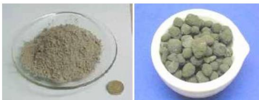
Slika 2. Razlika između cementa (lijevo) i klinkera (desno) [3].
