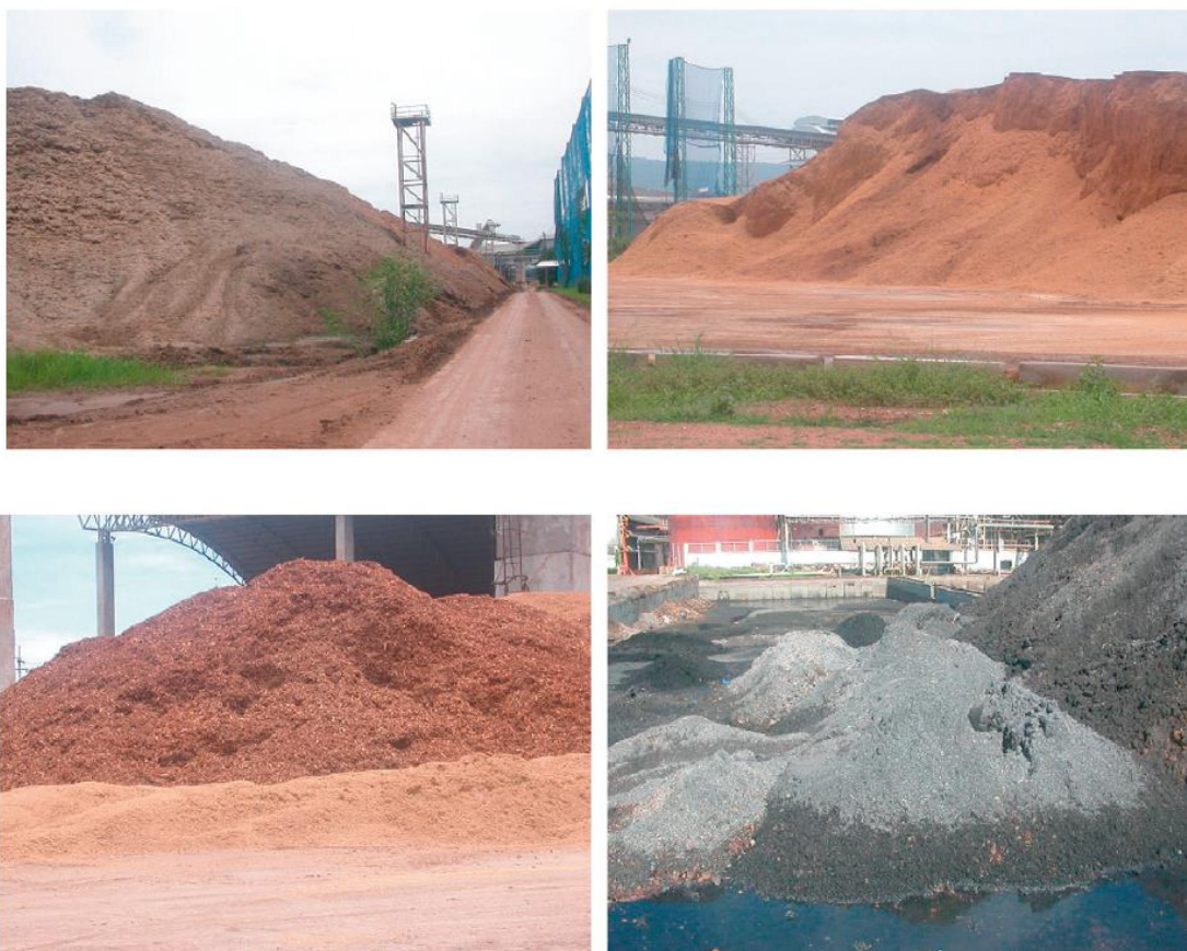
Slika 6. Sirovine kao gorivo i njihov otpadni pepeo: a) otpaci od prerade šećerne trske; b) rižina ljuska; c) nacijepana drva; d) BRWA [33].
