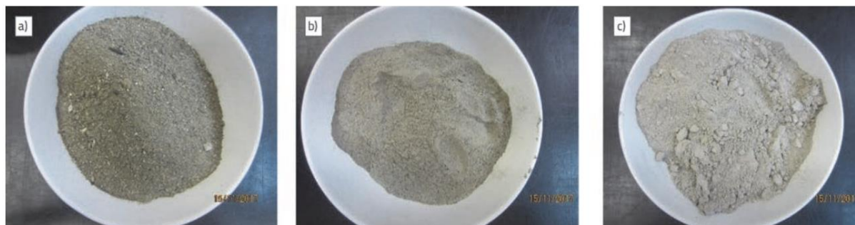
Slika 3. Uzorci pepela drvene biomase: a) pepeo s dna peći; b) leteći pepeo krupnije frakcije; c) finiji leteći pepeo [10].
