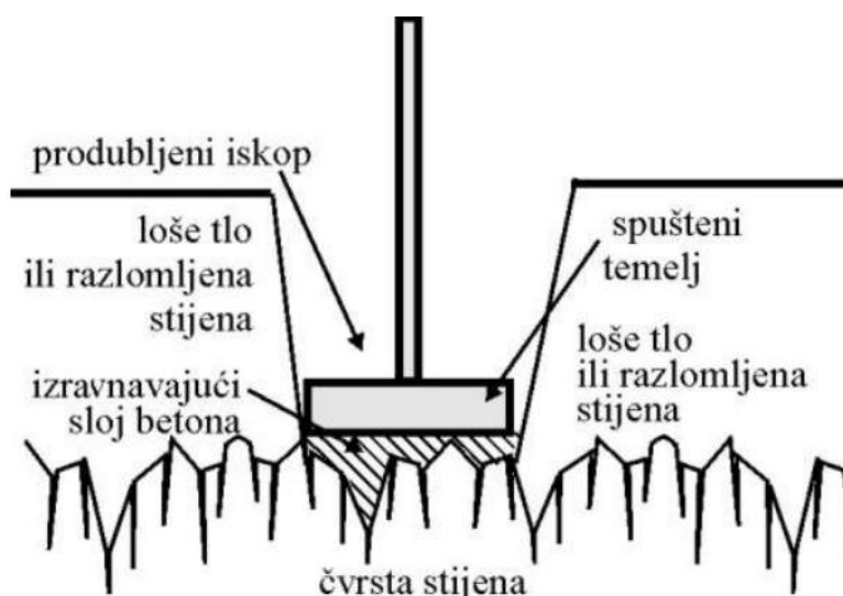
Slika 49 Produbljeno temeljenje
