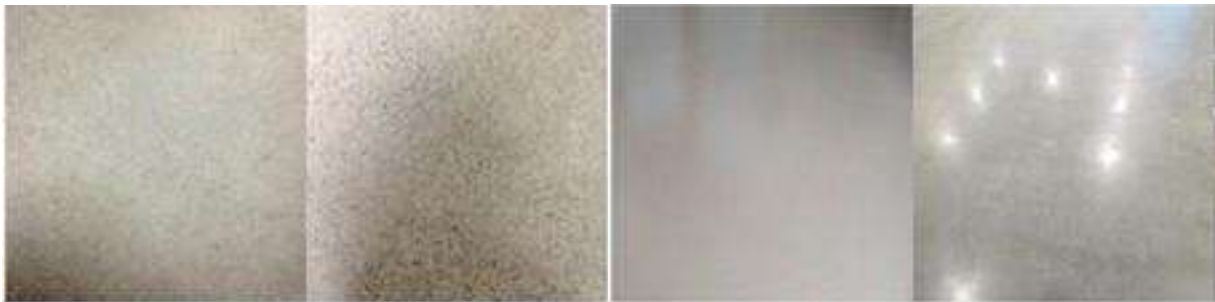
Slika 4.7. Stadiji poliranja betonskog elementa
