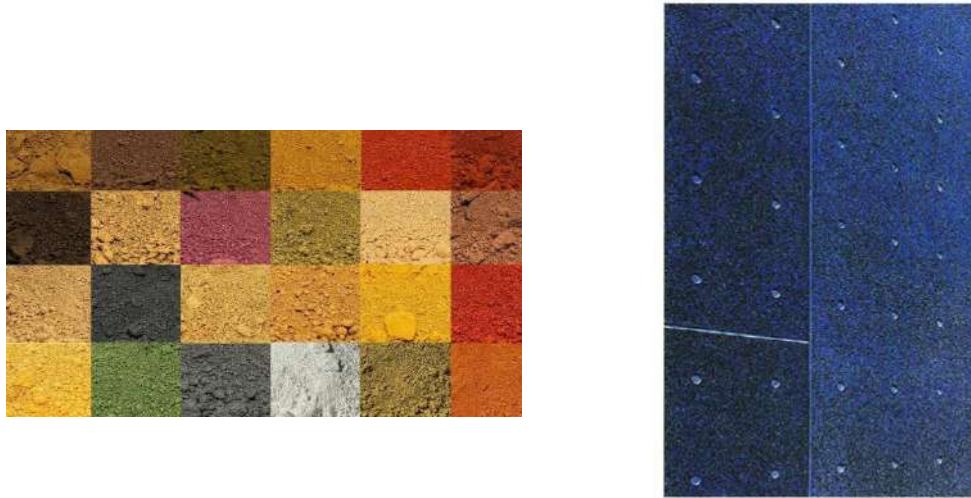
Slika 4.3. Nijanse pigmenta (lijevo), zid od plavog pigmentnog betona zaštićen premazom za vodootpornost (desno)
