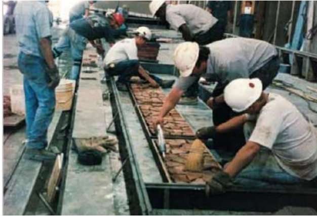
Slika 4.11. Ručno postavljanje kamena u kalupe elemenata
