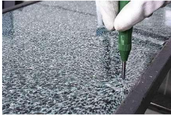
Slika 10. Lom kaljenog stakla
