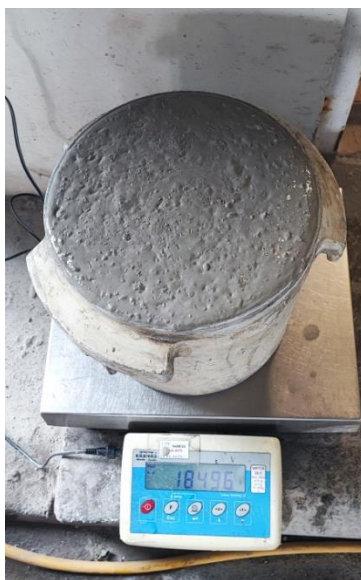
Slika 11: Masa svježeg betona
