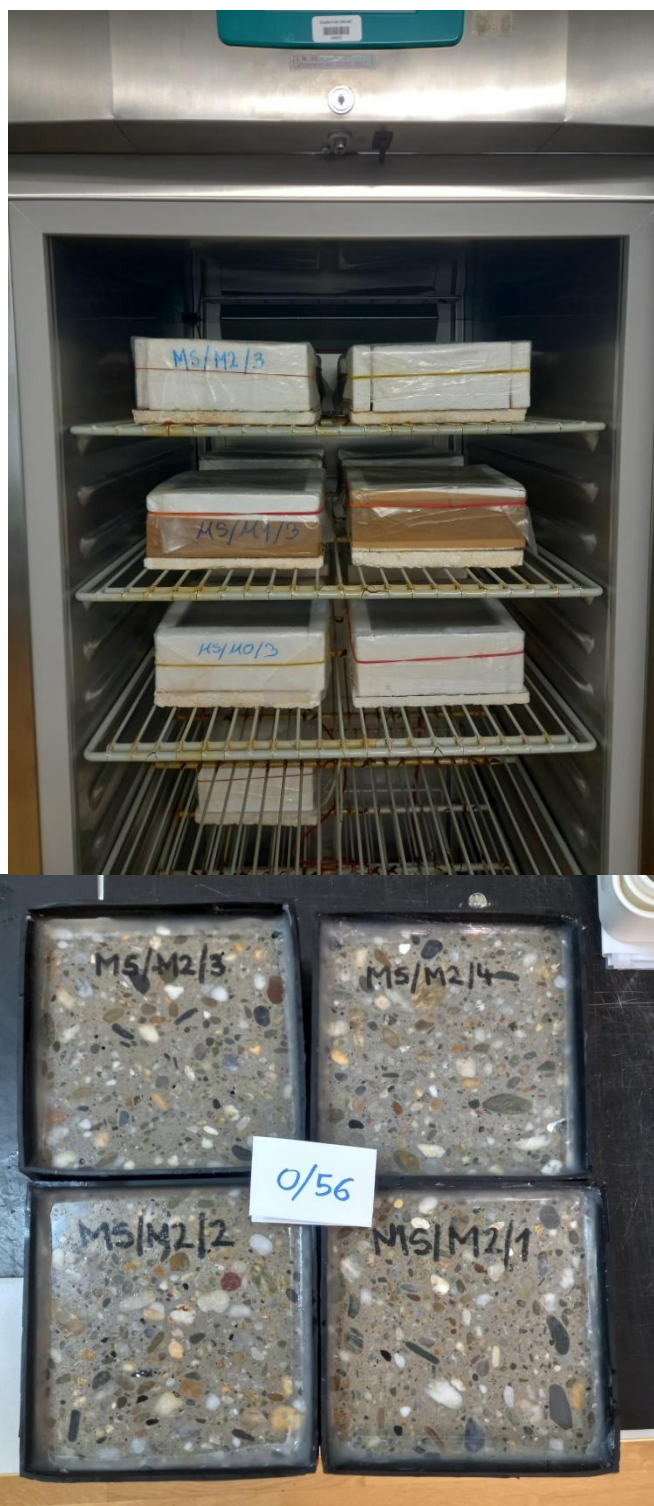
Slika 21: Uzorci prije spremanja u škrinju za ispitivanje otpornosti na mraz i sol
