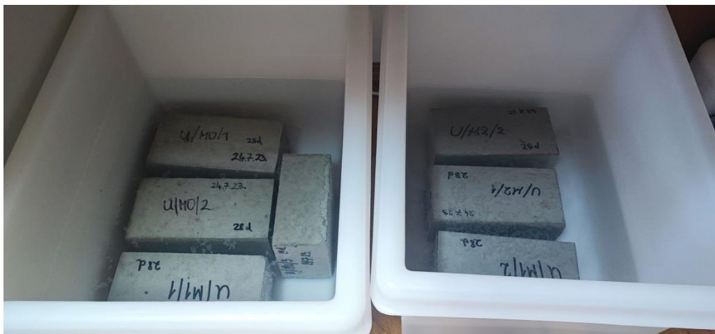
Slika 18: Uzorci za upijanje vode
