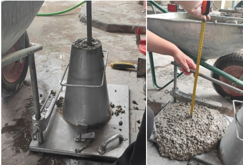
Slika 9: Prikaz slijeganja referentne mješavine M0
