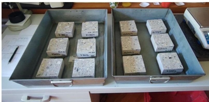
Slika 17: Uzorci za kapilarno upijanje
