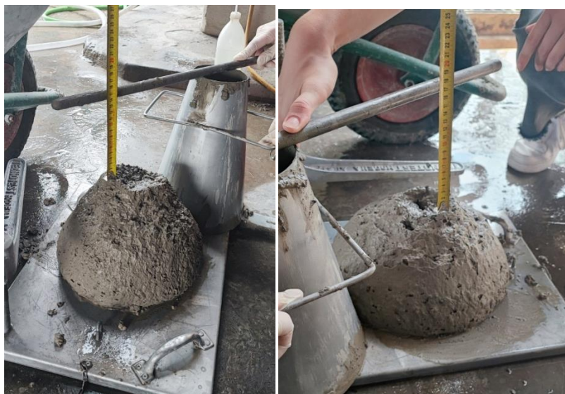
Slika 10: Prikaz slijeganja mješavine M1 i M2
