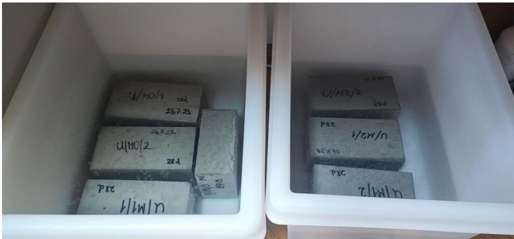
Slika 18: Uzorci za upijanje vode
