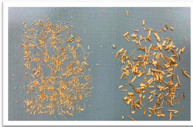
Slika 28 Vlakna miskantusa veličina 0-2 mm (lijevo) i 2-4 mm (desno) korištena u istraživanju [24]
