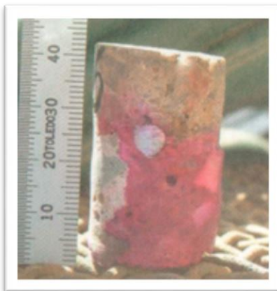
Slika 18 Ispitivanje dubine karbonatizacije fenolftaleinom [1]
