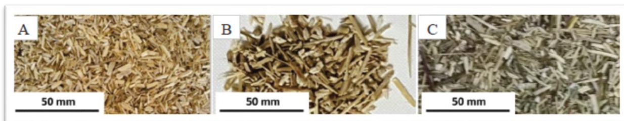
Slika 32 Veličine čestica agregata: A(konoplje), B(kukuruz), C(suncokret) [25]
