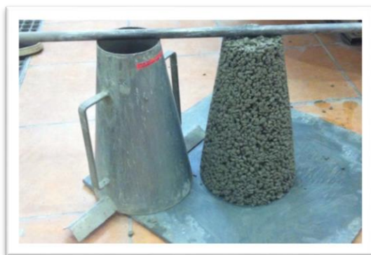
Slika 14 Lagani beton od jednakozrnatog agregata [8]
