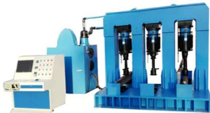
Slika 4.22. Uređaj za dinamičko i statičko ispitivanje tračnica [28]
