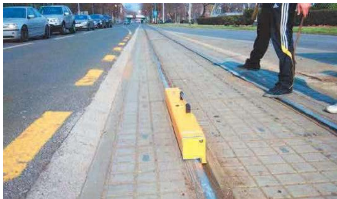
Slika 4.10. Uređaj za snimanje geometrije zavara RAILPROF1000 [19]
