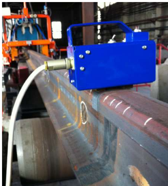
Slika 4.16. Defektoskop na bazi magnetskog toka [21]
