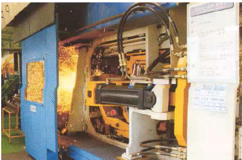
Slika 3.8. Elektrootporno zavarivanje u radionici [10]
