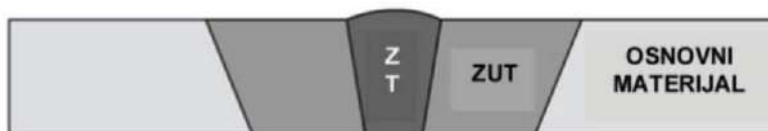
Slika 4.11. Presjek kroz sučeoni zavar (ZT-zona taljenja, ZUT-zona utjecaja topline) [7]
