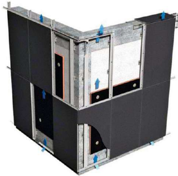
Slika 18. Okomiti sustav ugradnje ventilirane fasade
