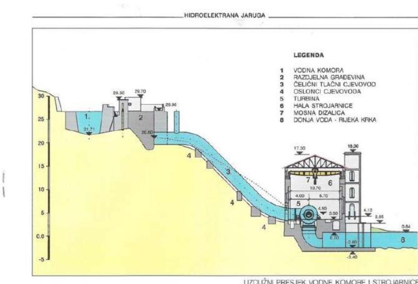
Slika 17: Uzdužni presjek vodne komore i strojarnice [3]
