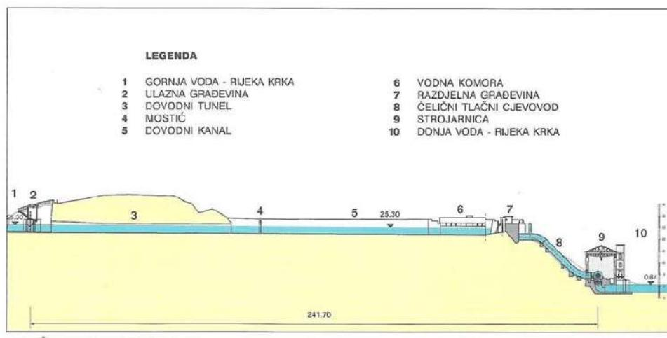
Slika 16: Uzdužni presjek postrojenja[3]
