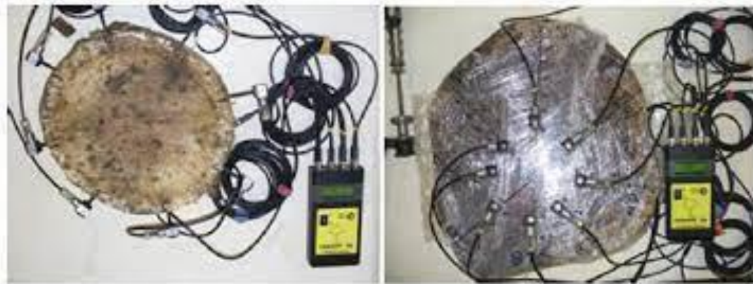
Slika 2. Prikaz pretvornika i pozicioniranja pinova kod ispitivanja u radijalnom smjeru (lijevo) i tangentnom smjeru (desno), (Bucur, 2011.)
