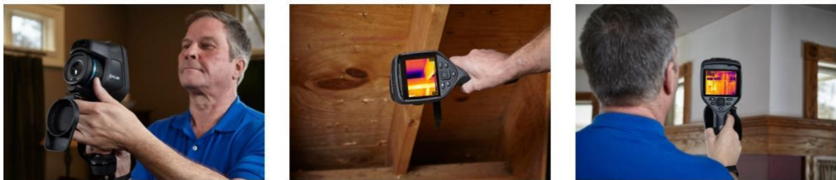
Slika 6. Termografsko snimanje građevnih elemenata od drva
