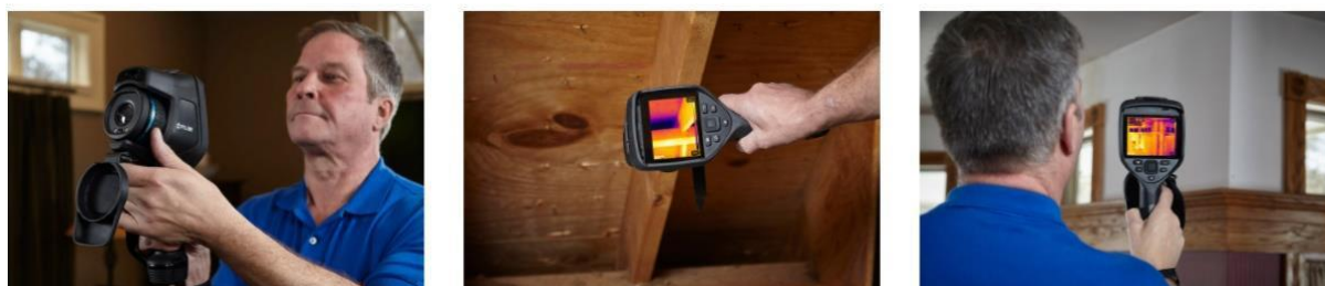
Slika 6. Termografsko snimanje građevnih elemenata od drva
