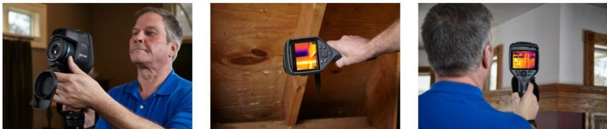
Slika 6. Termografsko snimanje građevnih elemenata od drva
