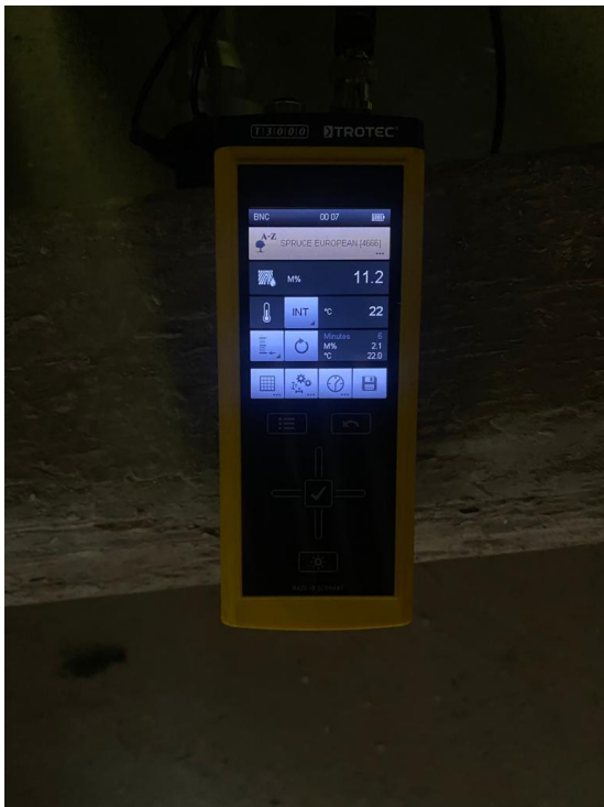
Slika 9. i Slika 10. Prvo mjerenje vlagomjerom
