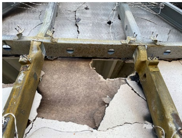
Slika 18 Čvorovi 6 i 7 nakon ispitivanja
