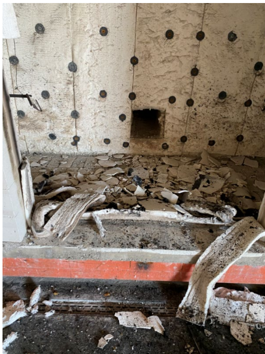
Slika 29 Detalj popucalih ploča nakon ispitivanja
