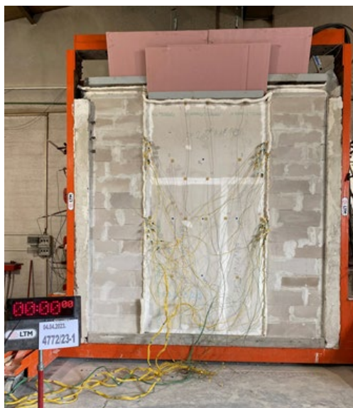
Slika 13 Požarna peć s ugrađenim ispitnim uzorkom i termočlancima na neizloženoj strani
