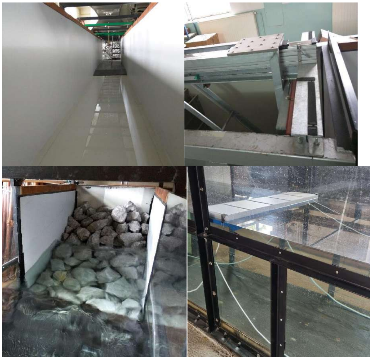
Slika 4 Valni kanal u Hidrotehničkom laboratoriju Građevinskog fakulteta u Zagrebu: valni kanal (lijevo gore), valni generator tip piston (desno gore), pasivni disipator valne (lijevo dolje), ponton (desno dolje)
