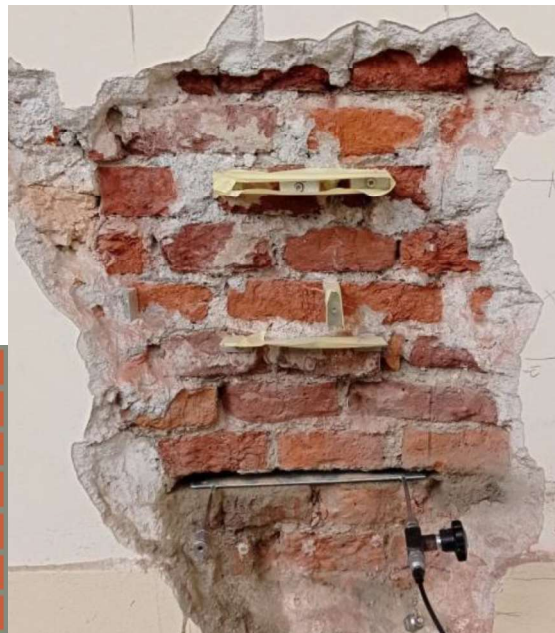
Slika 6 Određivanje vertikalnog naprezanja u zidu (Duvnjak, 2021)
