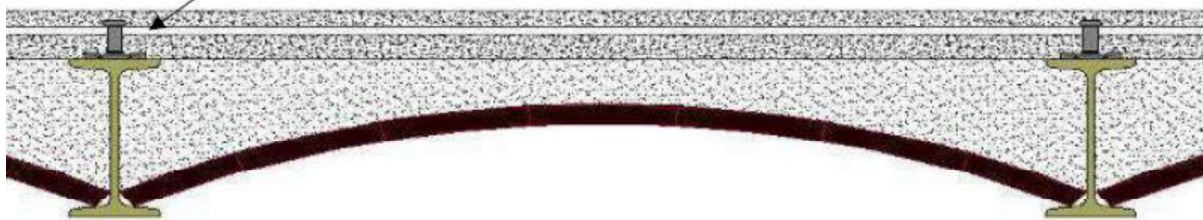
Slika 37 Presjek tlačne ploče 2.kata(Tarnik,2022)
