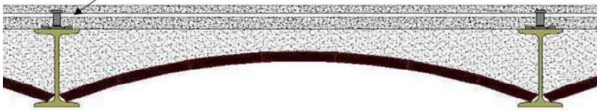
Slika 37 Presjek tlačne ploče 2.kata(Tarnik,2022)
