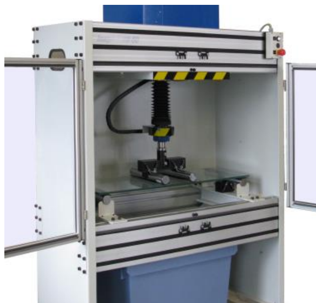
Slika 19 Laboratorijsko ispitivanje čvrstoće stakla [28]
