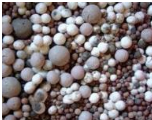
Slika 46 „Geofil Bubbles“ – ekspanirani stakleni agregat za lake betone [52]
