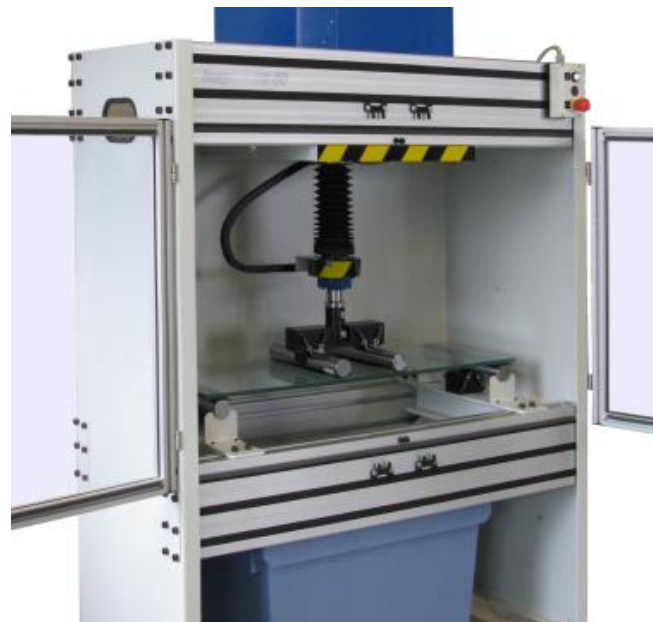
Slika 19 Laboratorijsko ispitivanje čvrstoće stakla [28]
