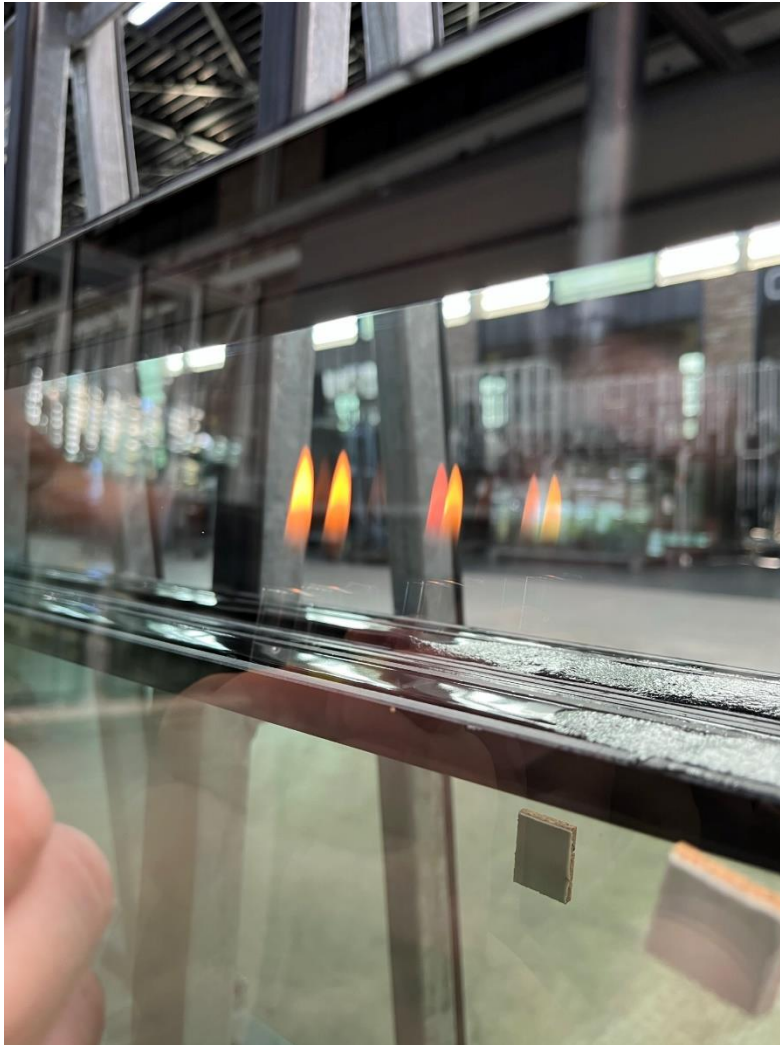
Slika 22 Primjer načina provjere na kojem staklu se nalazi low-E premaz
