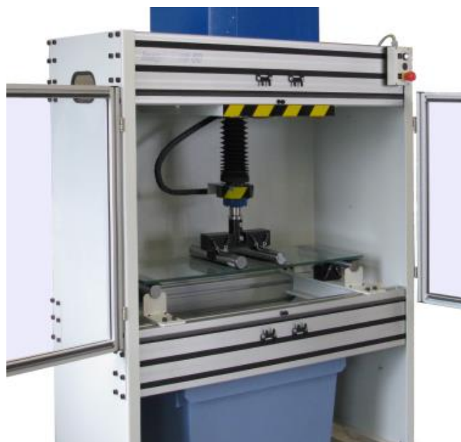
Slika 19 Laboratorijsko ispitivanje čvrstoće stakla [28]
