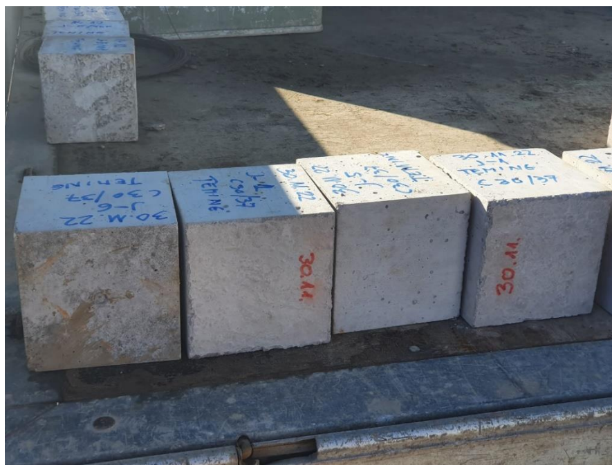
Slika 17. Uzorci za ispitivanje betona s ovog gradilišta
