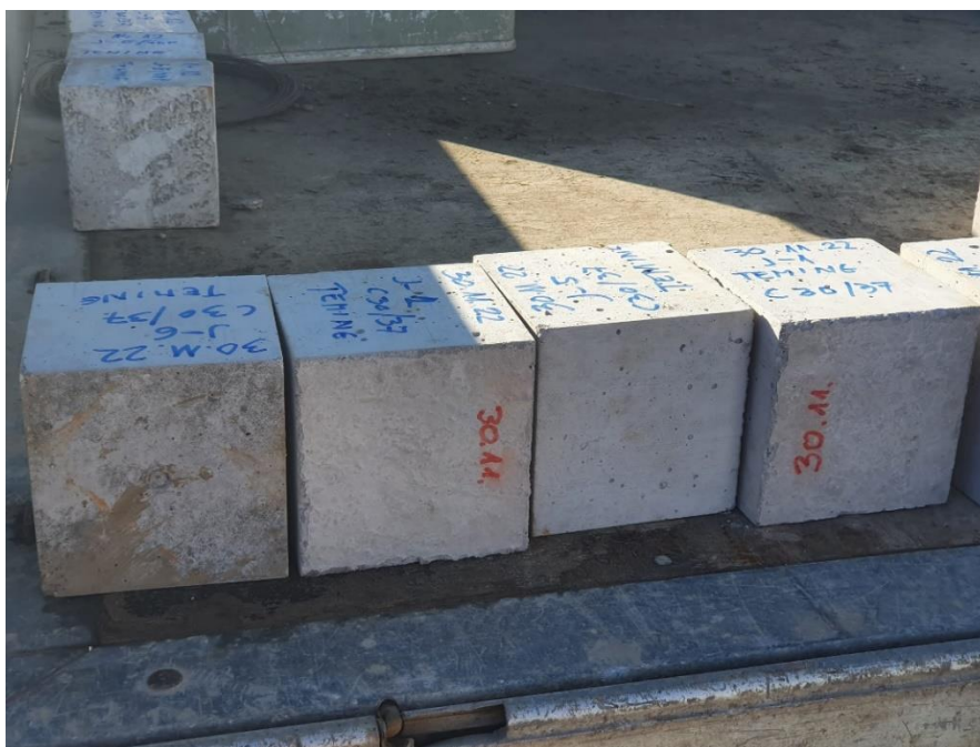
Slika 17. Uzorci za ispitivanje betona s ovog gradilišta
