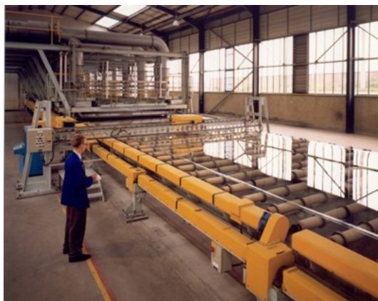
Slika 3 Float Glass proces (4)
