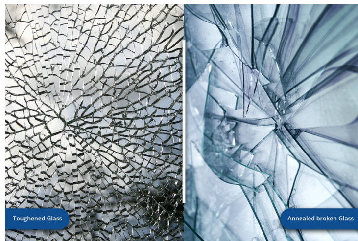
Slika 12 Razbijeno kaljeno staklo (lijevo) i sirovo staklo (desno) (14)
