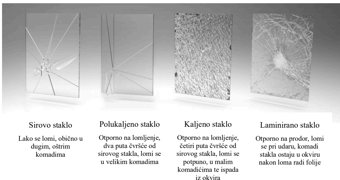
Slika 15 Usporedba lomova raznih obrada stakla
