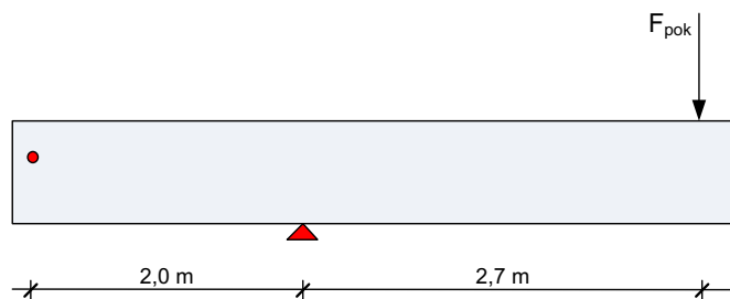
Slika 30 Shema opterećenja staklenog nosača nadstrešnice (29)
