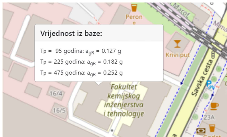
Slika 36. Prikaz povratnih perioda i ubrzanja tla (31)
