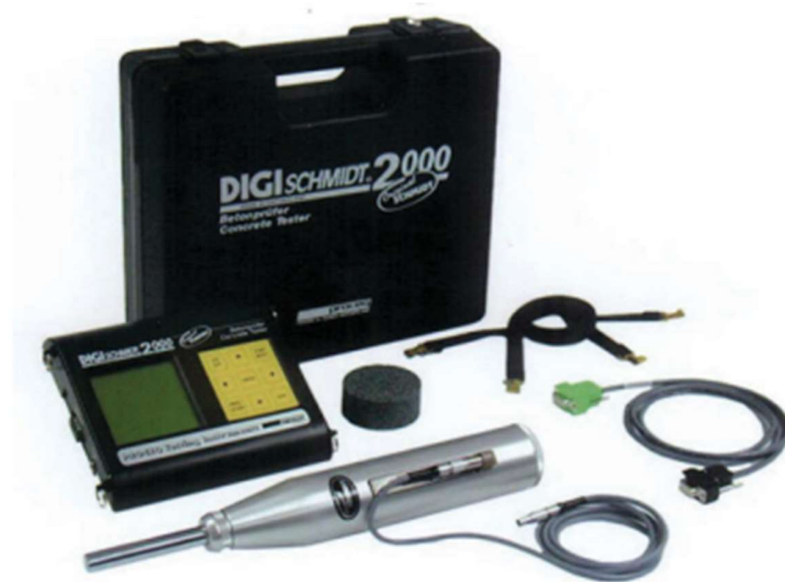
Slika 4. Sklerometar tipa Digi Schmidt (16)
