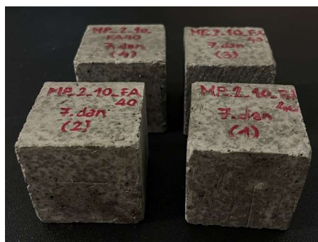
Slika 26. Uzorci Mix3 nakon raskalupljivanja.
