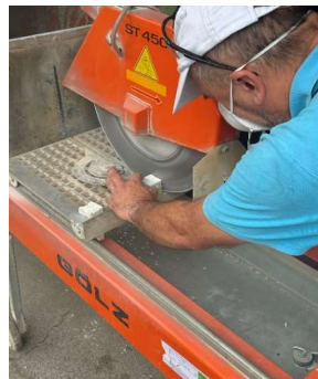
Slika 23. Piljenje uzoraka prizme 4x4x16 cm na uzorke kocke brida 4 cm
