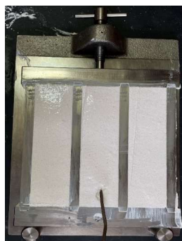
Slika 22. Ugrađivanje MPC paste u kalup dimenzija 4 x 4 x 16 cm i postavljanje termočlanka.
