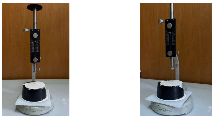
Slika 27. Prikaz ispitivanja vremena vezivanja pomoću Vicatovog aparata.
