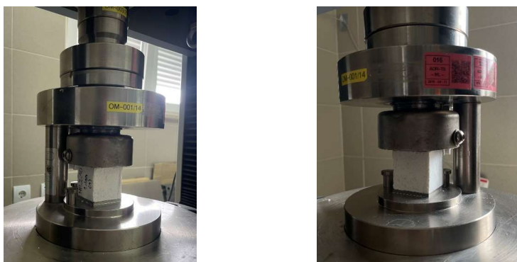
Slika 28. Prikaz ispitivanja tlačne čvrstoće pomoću preše.
