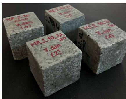
Slika 26. Uzorci Mix3 nakon raskalupljivanja.
