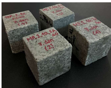
Slika 26. Uzorci Mix3 nakon raskalupljivanja.
