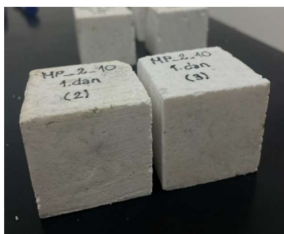
Slika 25. Uzorci Mix1 nakon raskalupljivanja.
