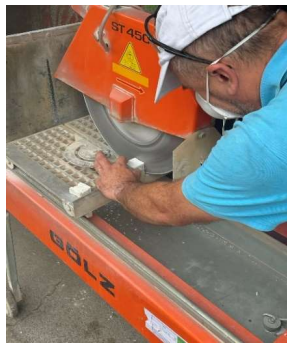
Slika 23. Piljenje uzoraka prizme 4x4x16 cm na uzorke kocke brida 4 cm
