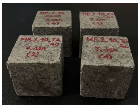
Slika 26. Uzorci Mix3 nakon raskalupljivanja.
