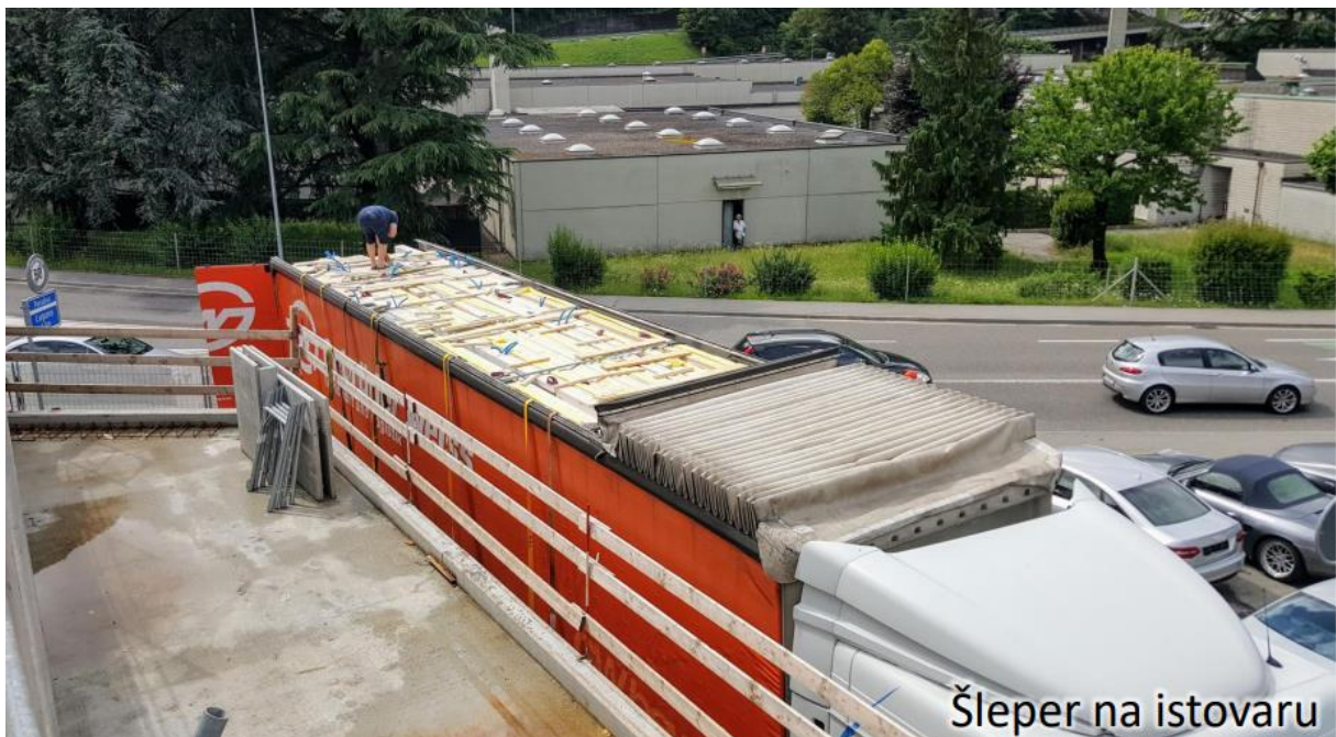
Slika 16 Domprojektov kamion s elementima za montažu(Izvor: Interni podaci tvrtke Domprojekt)
