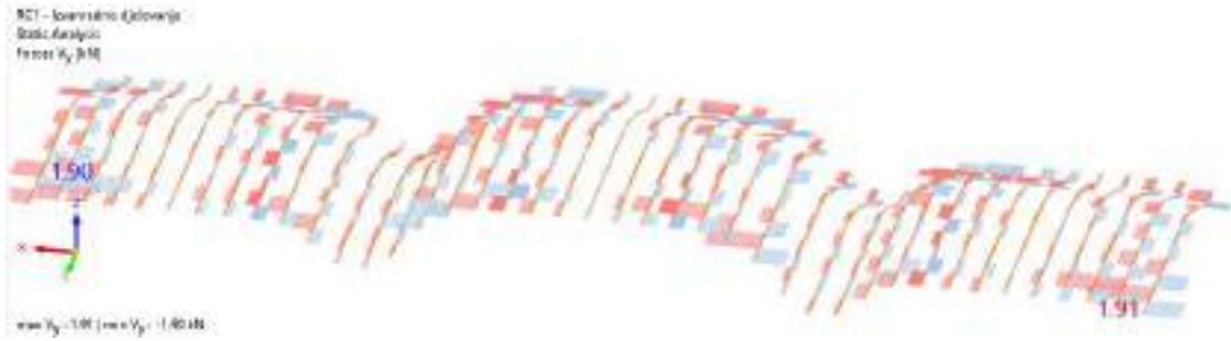
Slika 6.2 Dijagram poprečnih sila V_y [kN]
