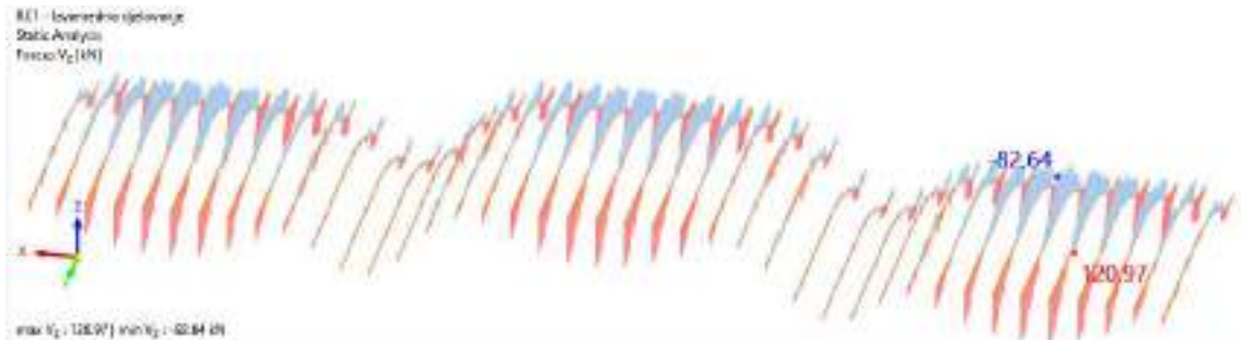
Slika 6.3 Dijagram poprečnih sila V_z [kN]
