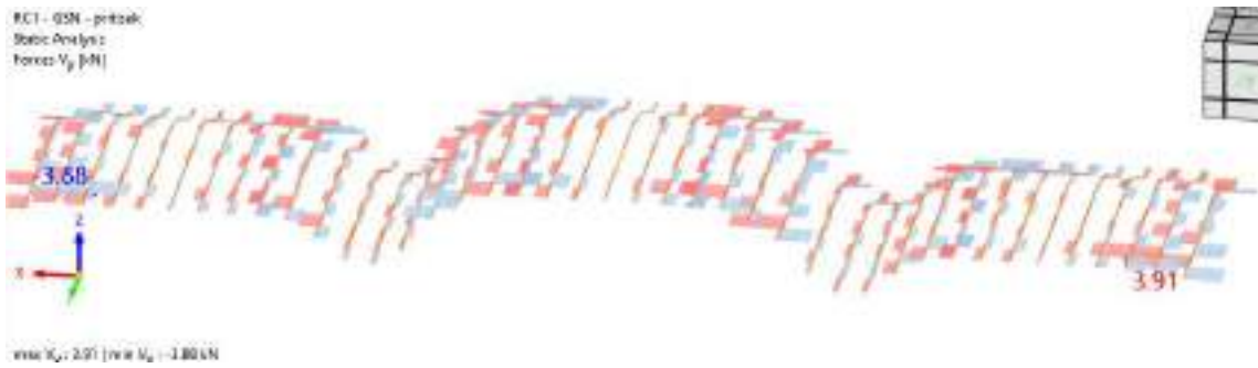
Slika 4.3 Dijagram poprečnih sila V_y [kN]
