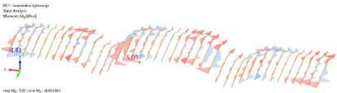
Slika 6.5 Dijagram momenata savijanja M_z [kNm]
