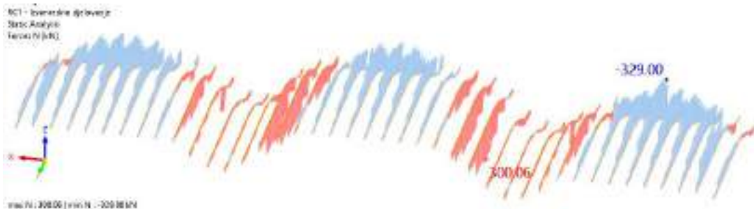
Slika 6.1 Dijagram uzdužnih sila N [kN]
