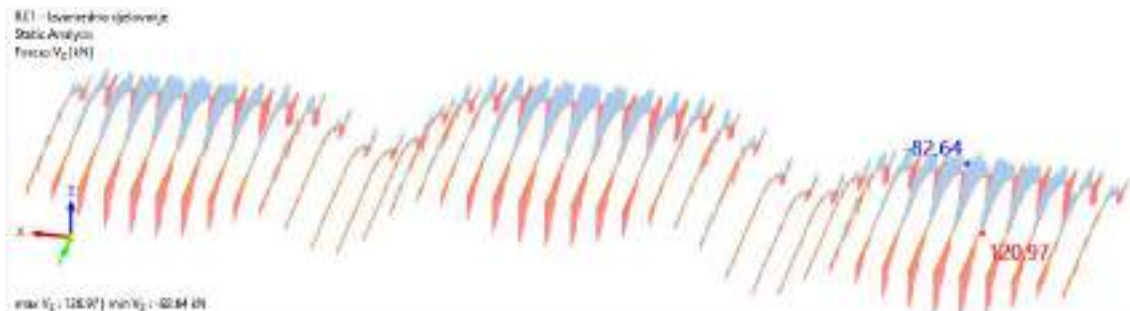
Slika 6.3 Dijagram poprečnih sila V_z [kN]
