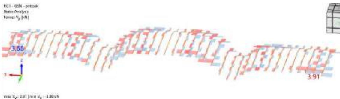
Slika 4.3 Dijagram poprečnih sila V_y [kN]
