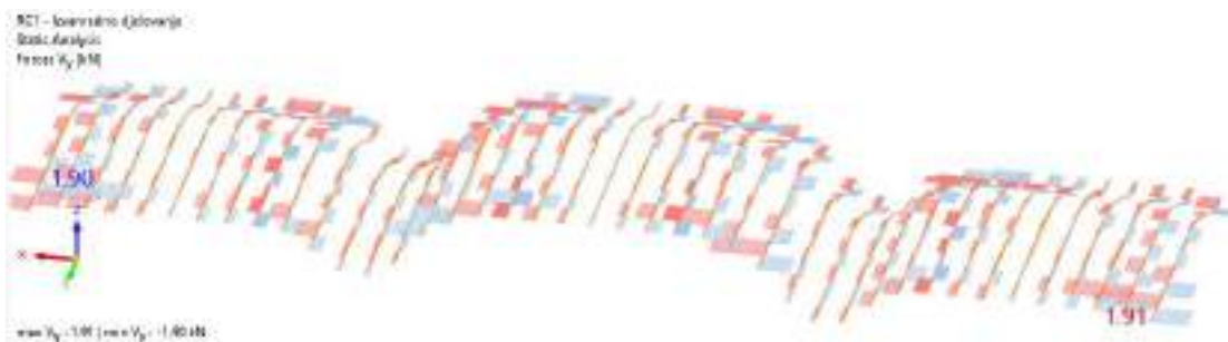
Slika 6.2 Dijagram poprečnih sila V_y [kN]
