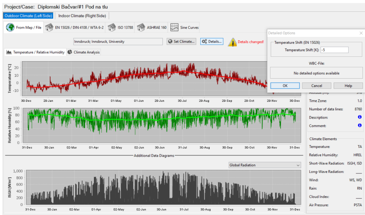
Slika 10.4. Vanjski klimatski uvjeti za pod na tlu
