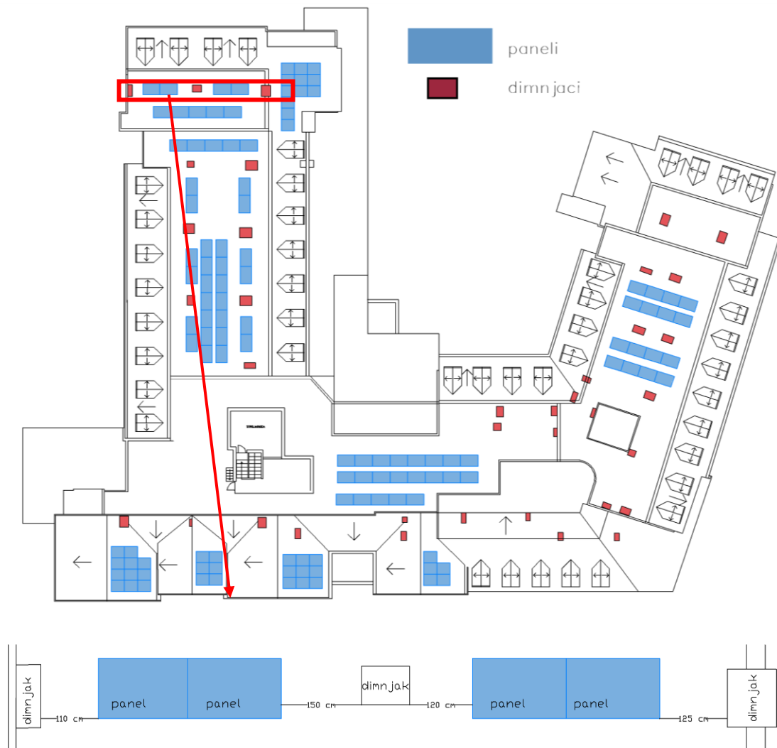
Slika 46 Položaj dimnjaka u odnosu na panele
