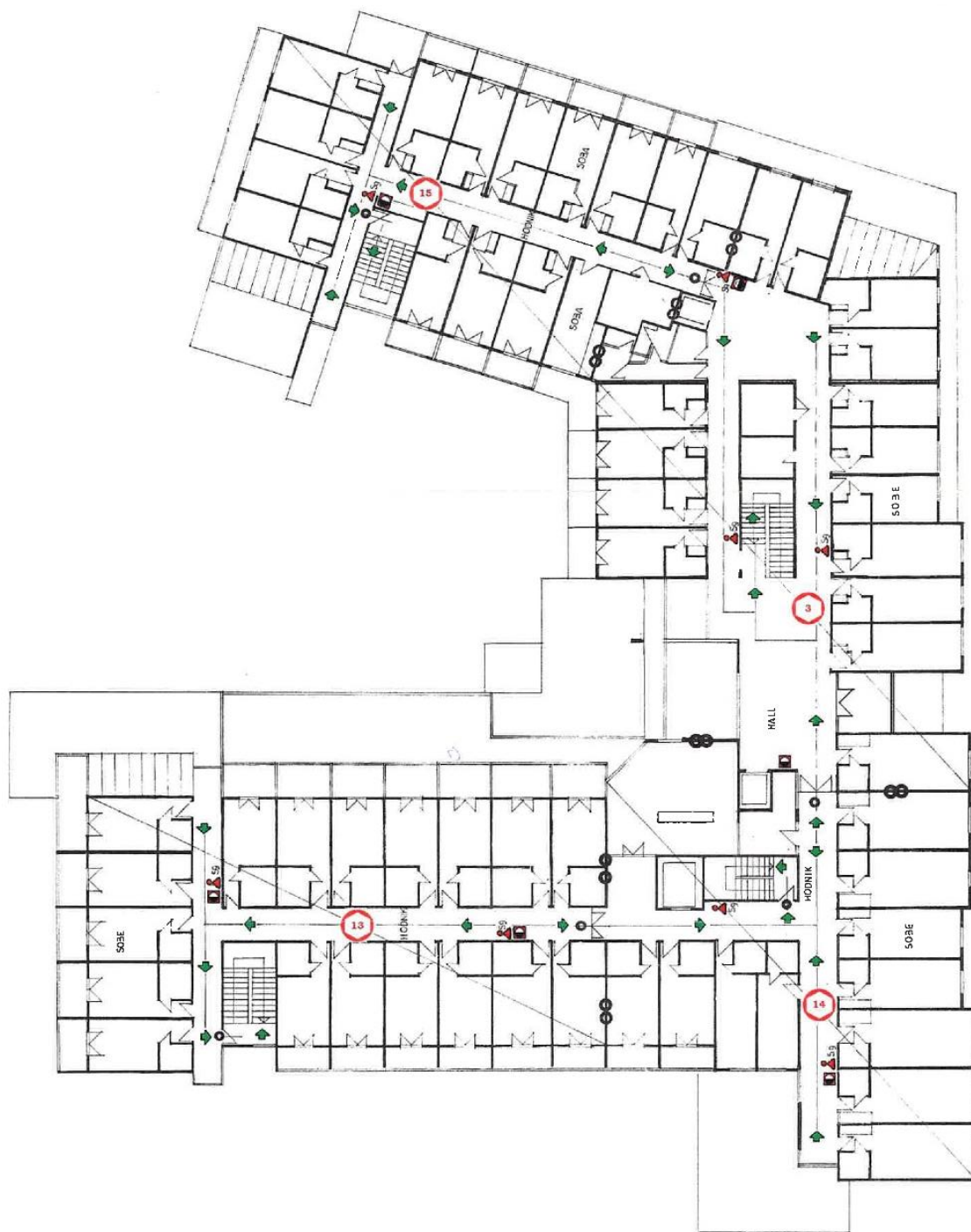
Prilog 4: Požarni odjeljci na 2. katu (45)
