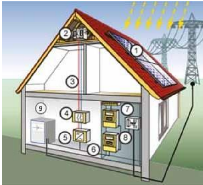
Slika 13 Komponente fotonaponskog sustava (31)
