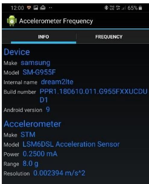
Slika 19. Specifikacije Samsung SM-G955F uređaja
