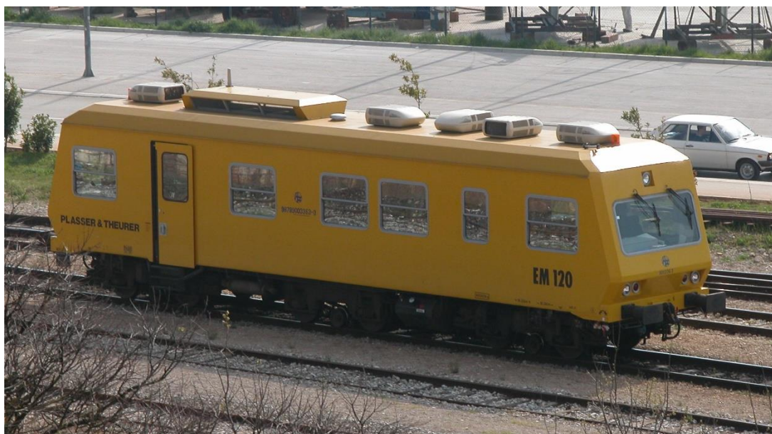
Slika 6. Tračničko mjerno vozilo EM-120
