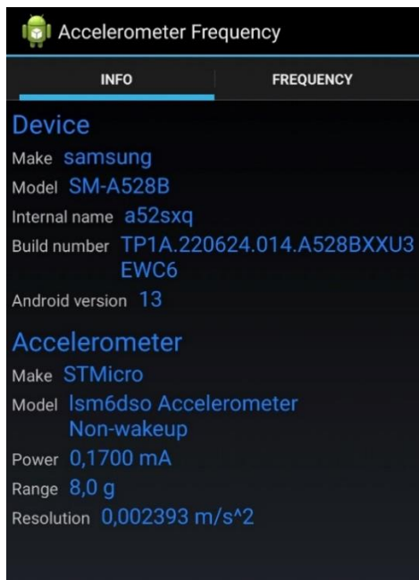
Slika 21. Specifikacije Samsung SM-A528B uređaja
