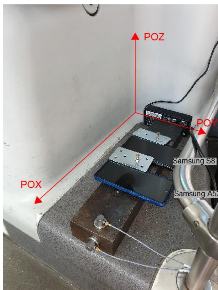
Slika 23. Položaj pametnih telefona u putničkom prostoru i položaja osi mjerenja akceleracija
